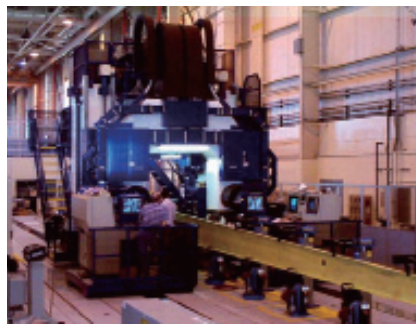
图2 E5000-ASAT IV自动化翼梁电磁铆接柔性装配系统
