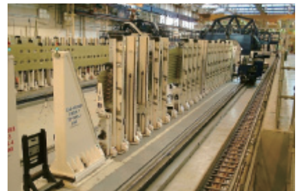
图3 A340飞机E4100机翼壁板自动电磁铆接装配系统
