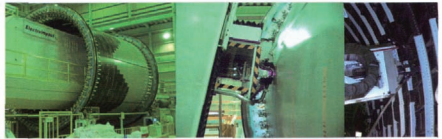
图1 波音787复合材料机身段的自动化电磁铆接装配系统
